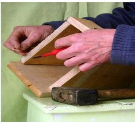
5. Taladra orificios de 3 mm de profundidad para colocar tornillos. Une las dos piezas de alambre por detrás antes de poner las piezas juntas. A tal efecto, perfora pequeños agujeros en la madera para pasar el alambre a través.
